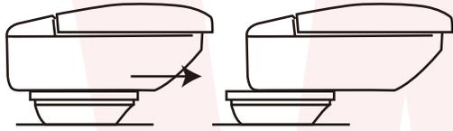
②スライドボードのレールの空いている部分が見えます。そこにスライドストッパーを差し込みます。これで、アームレスト収納ボックス自体をスライド移動して好みの位置に調整することができます。
