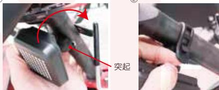
取り付けベルトを自転車のサドル(シートポスト)に巻きつけてください。巻き付けた後は取り付けベルトの突起をベルトの穴にひっかけて本体を固定してください。
