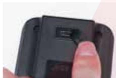
本体裏面の給電口のキャップを外してください。
