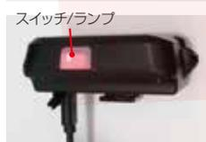
本体側面のスイッチ/ランプが赤色に点灯し、充電が始まります。充電が終わるとランプが消灯します。充電が済んだらUSBケーブルを抜いて給電口のキャップをはめてください。
