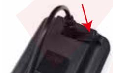
給電口に付属のUSBケーブルのmicroBコネクタを差し込みます。
