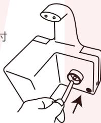
④ボトルを本体に取り付けます。チューブをボトル内に収めて、回して取り付けてください。
