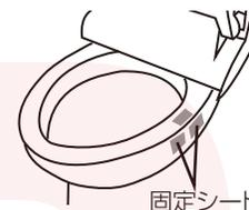
④固定シートの反対側のフィルムを剥がし、本体を固定します。しっかりとくっつけているか確認してください。
