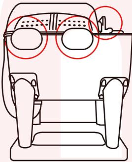
②ハンドルを中央の穴に差し込みます。穴の凹凸に合わせて差し込みます。ハンドルについているネジを少し緩め、ハンドルを差し込んだ後にしっかりと締めてください。
