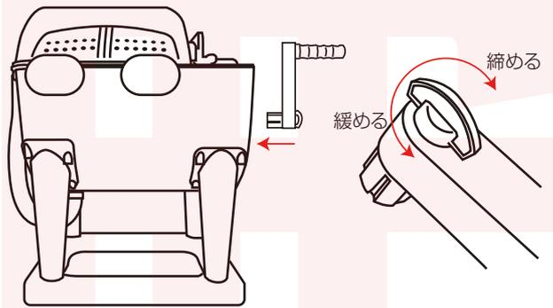
③時計回りにハンドルを3~5分回します。回す時には**必ず本体を手でおさえながら**回してください。汚れがひどい場合は回す時間を伸ばしてください。
