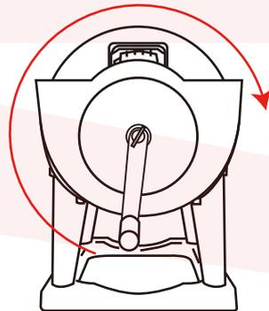
②ハンドルの持ち手を中央の穴から端の穴に差し替えます。ハンドルの持ち手が外側になるように方向に注意してください。中央の穴に差し込むよりも固いのでご注意ください。しっかり奥まで差し込んでください。その後ネジを締めてハンドルが外れないか確認してください。
