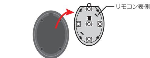
③基板の裏にあるコイン電池を薄いマイナスドライバーなどで押し出します。
