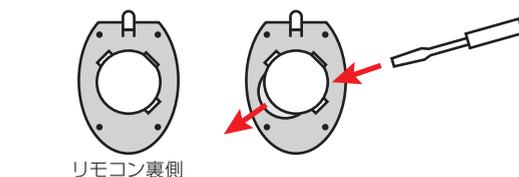
④新しいコイン電池を入れ、リモコンに基板を戻しカバーを取り付けます。
