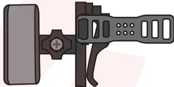
②固定用ホルダーを取り付けたいポールに当てて、固定用ゴムを巻き付けて反対側のゴムフックに引っ掛けて取り付けてください。
