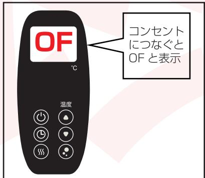
プラグをコンセントに差し込むと、リモコン画面に「OF」と表示されます。
