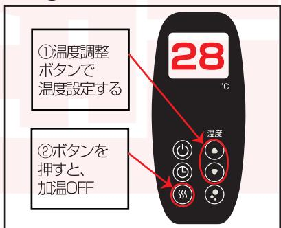
①電源が入りましたら、ヒーターによる加温が始まります。次に温度調整ボタンの▲▼を操作し、温度を設定してください。詳しくは次の項目「※温度調整について」をご確認ください。設定温度になりましたら加温が停止し、その温度を維持します。
