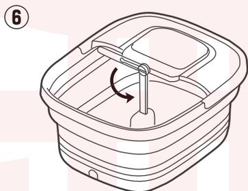
突っ張り棒を回して、ヒーター部の凹みに差し込みます。真ん中のネジを回して突っ張り棒を固定します。
