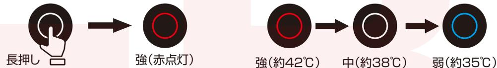
③電源を切る場合は、電源ボタンを長押しします。電源ボタンが消灯し、電源がオフになります。
