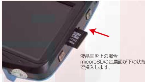
カードを抜く時は、カードを爪先で押し込むと、カードが出てきますので、掴んで抜いて下さい。
