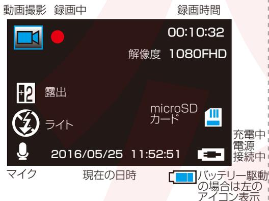
電源がオンになると、上図のような画面になり撮影がスタートします。車のエンジンが止まると、自動的に電源がオフになり録画もストップします。録画中に**モードボタン**を押すと、録画中のデータにロックがかかります。ロックがかかったデータは、ロックを解除するまで削除や上書きループされません。上選択ボタンを押すと、最大4倍までズームします。下選択ボタンでズームアウトします。
