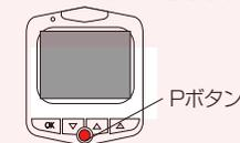
車のエンジンを切れている時、衝撃を感知すると自動的に電源が入り録画を開始します。1分間撮影後、自動的に電源がオフになります。
