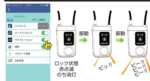
「バイブレーション」をONにします。ロックをして、Bluetooth接続が切れている状態で、振動が与えられると、一回アラーム音が鳴ります。続けて振動が与えられると、30秒間警告音が鳴り続けます。警告音を解除するには、Bluetooth接続をしてください。
