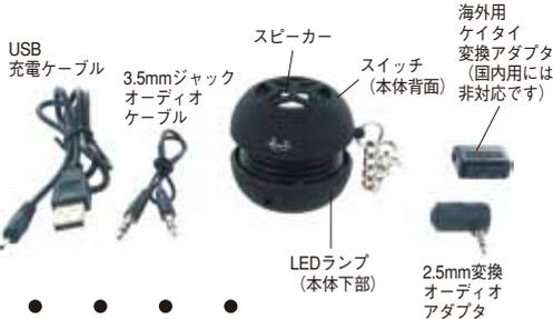
1. スイッチがOFFになっているか確認し、本体右側のUSB充電ポートにケーブルを繋ぎ、PCやUSBハブなどに接続し、充電します。約4時間でフル充電になりますので、接続を解除して下さい。約4時間ご利用いただけます。
