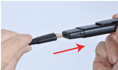
テレビと繋ぎ、カメラ本体の電源を入れます。テレビの入力切替をHDMIに変更して下さい。
