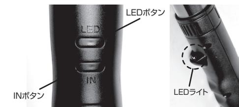
③LEDボタンを押すとLEDライトが点灯します。暗所でターゲットが見つからない時にご利用ください。LEDライトは再度ボタンを押すと消灯します。
