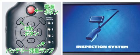
電源ボタンを押すと電源ON。もう一度押すと、電源OFF。電源が入るとオープニング画面が表示されたあと、カメラからの映像が映し出されます。(撮影画面)
