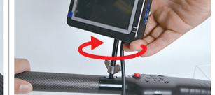
コントロールハンドル先端部のネジ穴に、モニターのアームネジ回して入れていきます。
