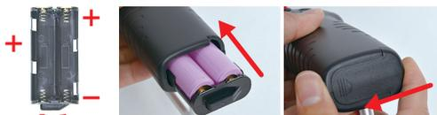
電池ボックスの+の向きに注意して、電池を入れます。電池ボックスを戻して、しっかりとカバーを閉めます。
