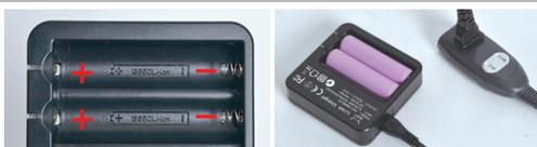
充電器に充電電池の向きに気を付けてセットします。充電用ケーブルを繋げ、コンセントに差すと充電が開始されます。
