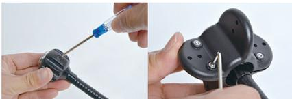
カメラ先端部に差し込み、ネジ締めて固定します。
