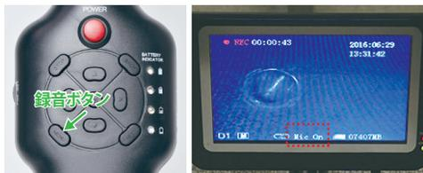
録画中、録音ボタンを押すとマイクON。もう一度押すと、マイクOFF。画面中央下にマイクON時[Mic On]、マイクOFF時[Mic Off]と表示されます。
