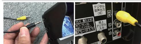
モニター左側面に[VIDEO OUT]端子（3.5mmジャック）があります。映像ケーブル（別途ご用意）を繋ぐ事で、外部モニターに映像を表示することができます。
