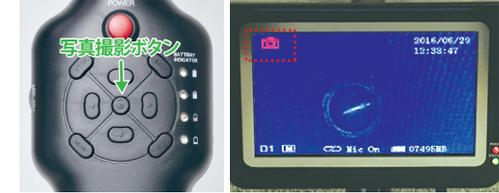
写真撮影ボタンを押すと、撮影します。撮影した瞬間、画面左上に写真アイコンが表示されます。
