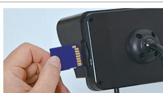
モニター右側面にSDカードスロットがあります。SDカードの向きに注意して「カチッ」と音がするまで押し込みます。もう一度軽く押し込むと取り出せます。
