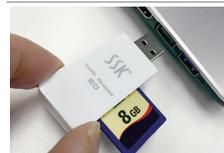
パソコンにSDカードスロットがないときにお使いください。リーダーにSDカードを差し込みパソコンのUSBポートに差せば、SDカードのデータをパソコンから確認することができます。
