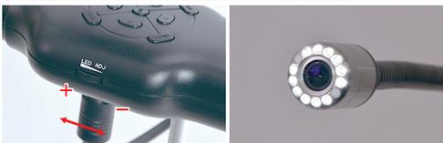
コントロールハンドル左側面にある調光スライドで、ライトの明るさを無段階で調節できます。マイナス方向一杯までスライドさせるとライトは消えます。
