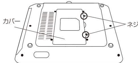
本体の背面にあるネジを、+ドライバー(別途をご用意ください)を使ってはずし、カバーを取り外します。
