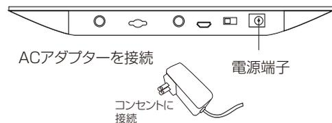
付属のACアダプターを、電源端子に接続します。反対側をご家庭のコンセントに接続してください。自動的に充電が開始されます。
