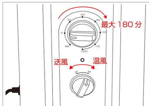
⑤ 「熱風・冷風切り替えスイッチ」を熱風にあわせます。そのあと、タイマーをセットします。
