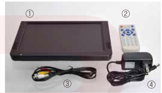
①モニター ②リモコン ③AVケーブル(100cm) ④ACアダプタ(150cm)
