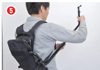
一度、セットしたいカメラ位置になるよう各ポールの角度調節をします。
