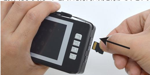
カチッと音がするまで押し込んで下さい。microSDカードは少しルーペ本体から出ている状態になります。microSDカードを外す時は、奥に一度押し込むと、先が出てきますので抜いて下さい。
