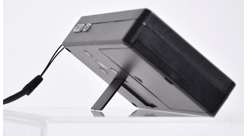
台座・スタンドを使用せずにループを使用する事もできます。距離でピントを調整して下さい。
