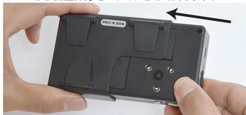
電池カバーを外し、単4電池3本を図のように入れて下さい。セットができたならカバーを閉じて下さい。
