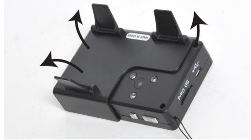
足を立てて使用すると、自動的にピントが合う距離になります。画面が暗い場合は、本体上面のLEDボタンを押すと、ライトが点灯します。
