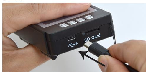
ケーブルの反対側をPCやUSB-ACアダプタ(別売)に差し込むと、自動的に本体の電源が入ります。
