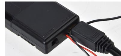
ケーブルは、先にカメラ本体に差し込み、その後給電元であるパソコンやUSB-ACアダプタにUSBを差し込んでください。差し込む順番が変わると、正しく充電できない場合があります。
