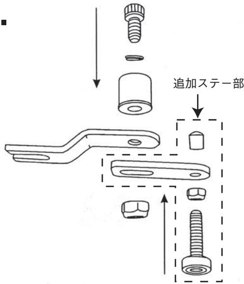
ステー安定用ブラケットの取り付けにより、2点で支えより安定感が増します。
