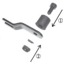
B-2. シートを固定しているネジを外し、B-1のブラケットを差し込み、ネジを固定し直します。
