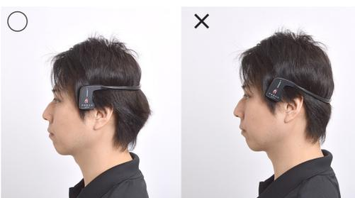
左の写真のように水平に装着して下さい。斜めに装着するなどした場合は、正しく音が伝わらない場合があります。
