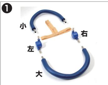
小バーを上、大バーを下に、バーのへこみの方向を合わせます。ジョイントのプッシュピンを内側に。各パーツを配置します。
