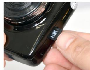
爪の先などを使って、「カチッ」とカードが押し込まれるまで差し込んで下さい。取り出す時は爪の先でカードを押し込むとバネの力でカードが飛び出ます。
