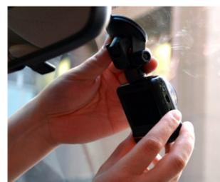
本機に吸盤アタッチメントを取り付け、フロントガラスに設置して下さい。「LDWS/FCWS」を有効に活用する場合には後述の「LDWS/FCWS を利用する」をご確認ください。
