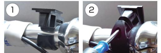
① バイクホルダーのネジをプラスドライバー(別途ご用意ください)で外し、ハンドルバーやフレームに付けます。(太さによりゴムバンドで調整します)
