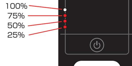
電池の残量は、図のようにパーセンテージで表示されます。フル充電時は4つのランプすべてが点灯します。75%以上の場合は下から3つのランプが、50%で2つ、25%以下の場合には下のランプ1つのみ点灯します。(充電式乾電池の充電時も同様です。)
