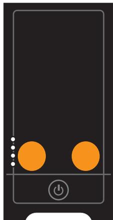
オレンジ色の場所が音声増幅用センサーの位置になります。この部分に音源がくるように、場所を調整して、ご利用ください。
