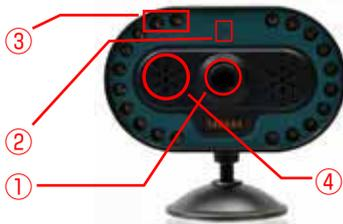
①瞳センサー(左右20個) ②瞳センサー稼働ランプ ③赤外線LED ④スピーカー
