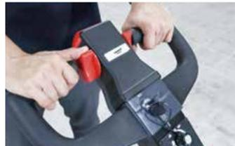
前進・後進操作は、手元のレバーを倒すだけの簡単操作です。
