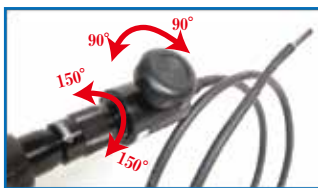
接続部のダイヤルを回すと先端が左右90度ずつ曲がります。更にチューブ全体も左右に150度ずつ回転が可能です。
