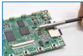
側視鏡を付ければ接写状態でも焦点が合います
