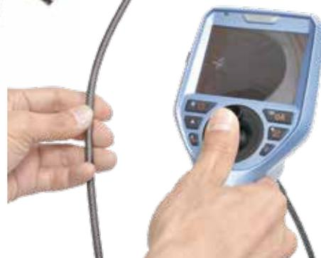
最大 120 度までの高温に対応した先端が 360 度可動する内視鏡です。コンプレッサーが付属しており、ケーブルとエアホースを接続すると、カメラ先端部から風が出て、内部を冷やしながらか観察することができます。
