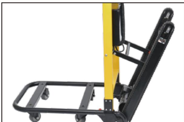
台車の背面にある走行ベルトは、カタピラのような凸凹と滑りにくいゴムで、階段の段差でも昇り降りすることを可能にします。使用するときには、走行ベルトを倒して角度をつけて、階段に走行ベルト全体が接するように倒しながら進みます。
