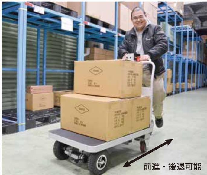
電動アシストがついた台車により、重量物運搬作業による体への負担軽減。安定した運搬で荷ぐすれ軽減、倉庫内での運搬作業効率化アップ。電源を入れて、台車のハンドルバーを持ちながら手で電動アシストモーターを動かす簡単操作。スピード調整機能に、前進、バックもでき、万が一の緊急停止ボタンもあります。約8～9時間ほどでフル充電して、約4時間可動。
