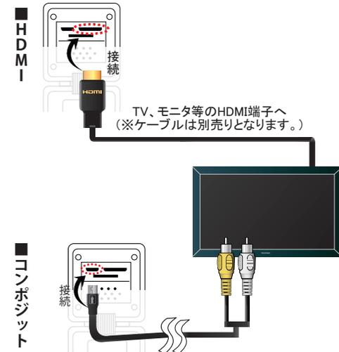
上記の様に接続後、本体の電源をONにすることで自動的にテレビに映像が出力されます。
