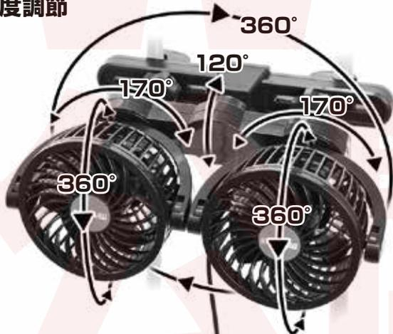
ファンは上下左右 360° 回転。土台は左右 360° 回転 上下約 120° 傾けられます。土台の角度を調整するときは、リングネジを緩めます。角度を決めたらリングネジで固定します。
