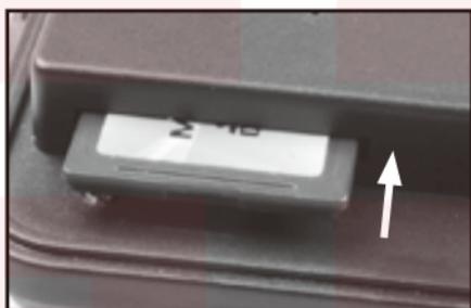
ラベル面を上にして、カチッと音がするまで奥に押し込んで下さい。取り出す場合にはカードを少し押し込むとバネの力でカードが押し出され取り出すことができます。
