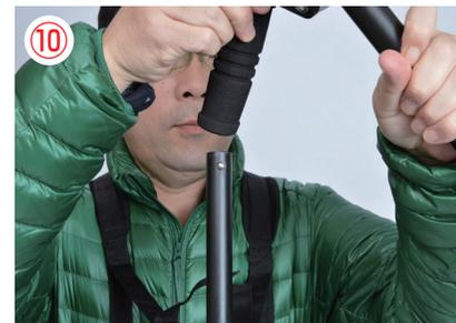
⑩ 「サポートチューブ」の先端に、セッティングしたカメラスタビライザーのグリップ底部の穴に差し込みます。
