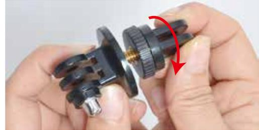
分けたネジ側を防水ケースの三脚穴に取り付けます。この部品が、すべてのマウントを取り付けるパーツになります。
