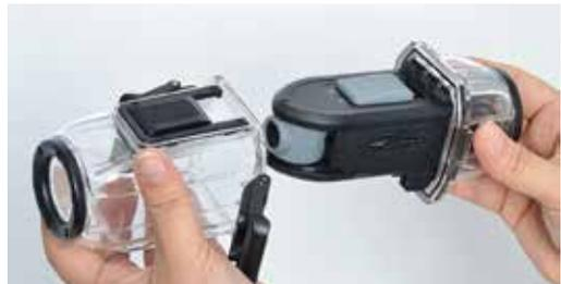
②防水ケースの長い方に、リアカメラ側を入れて、二つの固定レバーを下ろして閉めます。しっかりと防水ケースの両側が固定されているか確認して下さい。
