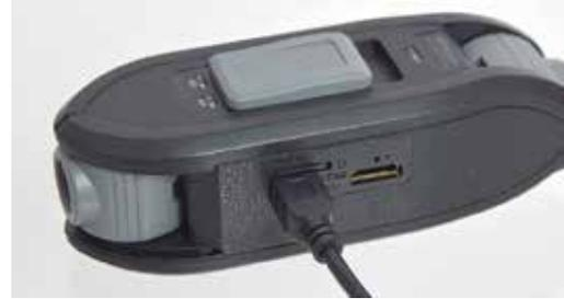
USB側をパソコンやUSB-ACアダプタ（別売）に差し込んで下さい。起動音が鳴り、充電が開始され、本体上部の電源ライトが赤に点灯します。充電が終了するとライトが消灯しますので、ケーブルを抜いて下さい。充電しながら録画する事も可能です。
