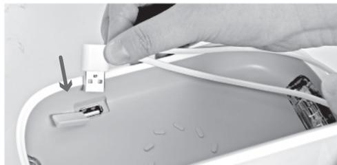
③お使いのスマートフォンに充電用ケーブルを接続します。充電用ケーブルはLightningとmicroUSBの二股になっています。お使いの機種に合わせて接続してください。
