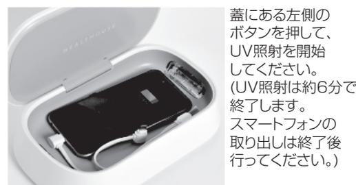
蓋にある左側のボタンを押して、UV照射を開始してください。(UV照射は約6分で終了します。スマートフォンの取り出しは終了後行ってください。)
