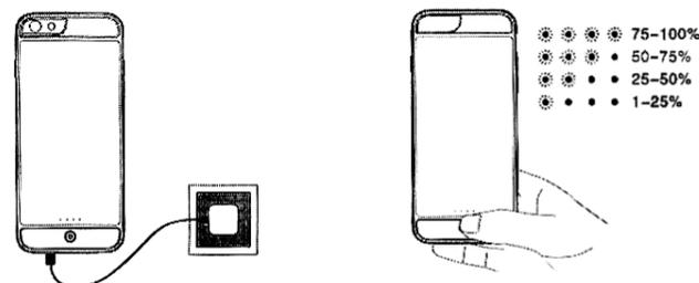
2. ケース背面のパワースイッチを押すと、バッテリーケースの残量が確認できます。
