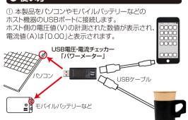
② 測定するUSBデバイスを本製品に接続します。 計測された「電流値(A)」と「電圧値(V)」が交互に 表示されます。
