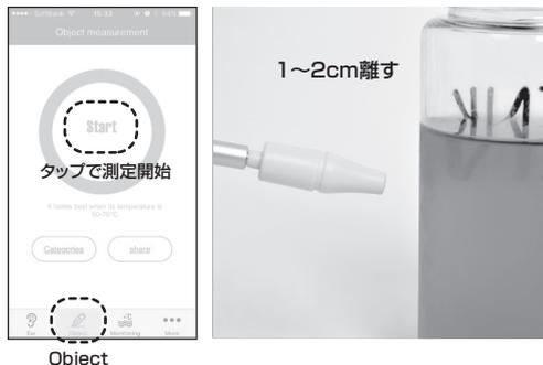
※液体を測定する時は液体表面または容器の側面から1~2cm離して測定してください。本製品を液体の中に入れてください。故障の原因になります。
