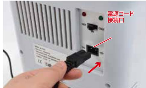
車での使用の場合は本体背面の電源コード接続口にシガーソケット用コードを接続し、反対側のプラグをシガーソケットに接続してください。
