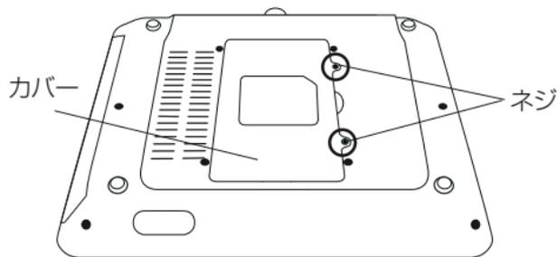
本体の背面にあるネジを、+ドライバー（別途ご用意ください）を使ってはずし、カバーを取り外します。
