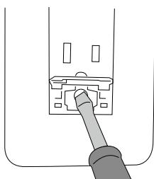
(1) マイナスドライバー等でアース端子のフタを開けアース線取付用のネジをゆるめます。
