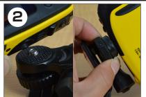
本体のカメラネジを、お使いのカメラ底 部のネジ穴に合わせ、つまみを回して固
