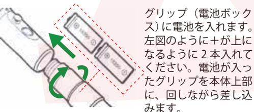
グリップ(電池ボックス)に電池を入れます。左図のように+が上になるように2本入れてください。電池が入ったグリップを本体上部に、回しながら差し込みます。
