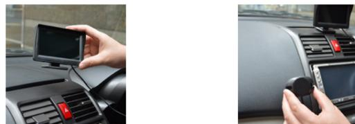
2. AとBケーブルを接続し、シガーソケットアダプターより給電して下さい。シガーソケットアダプター上部の赤い主電源ボタンを押すと立ち上がります。
