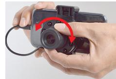
被写体にピントが合わようようにフォーカシングを左右どちらかに回して調節します。
