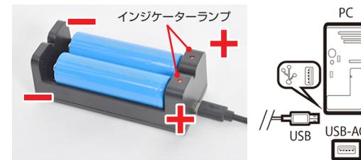
充電器に充電器用ケーブル(microUSBコネクタ側)を挿します。反対側(USBコネクタ)をパソコンまたはUSB-ACアダプタなどに繋げてください。
