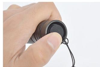
電池カバーには電源ボタンがあります。カチッと音がするまで押し込むと、赤外線ライトが付きます。もう一度カチッと音がするまで押し込むと消えます。電源を入れると奥の発光部が赤く光るのがわかります。
