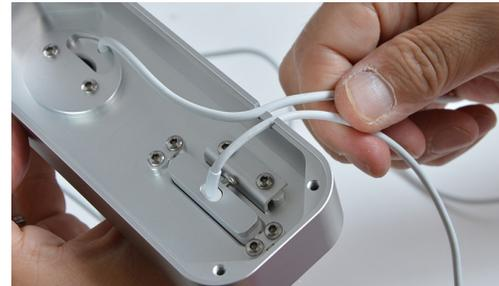
⑤土台に底板を取り付けます。ネジA(ネジ頭が平らなもの)を使用し、付属の六角レンチで4か所ネジを留めます。
